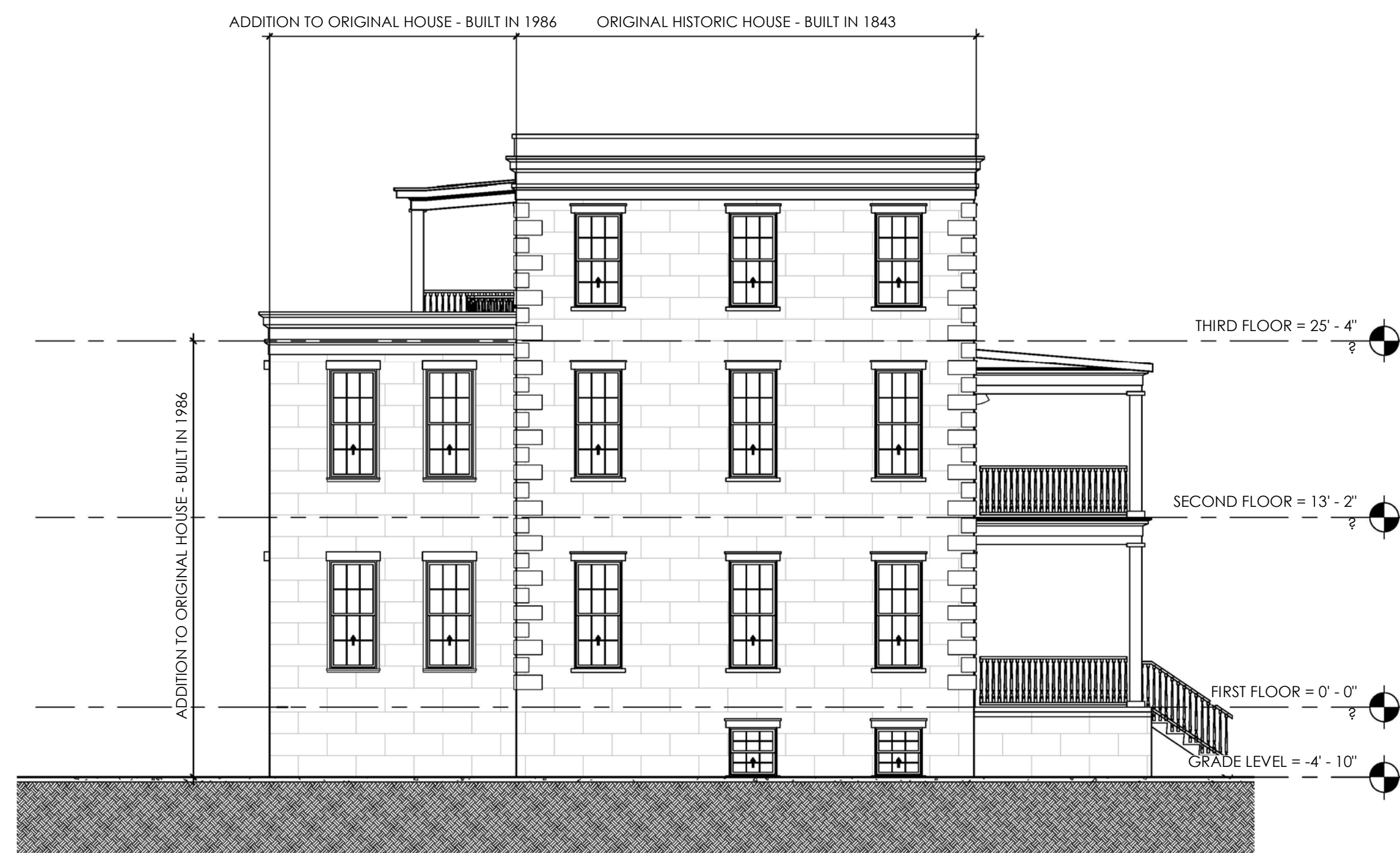
3 WEST ELEVATION - EXISTING SCALE: 1/8" = 1'-0"
